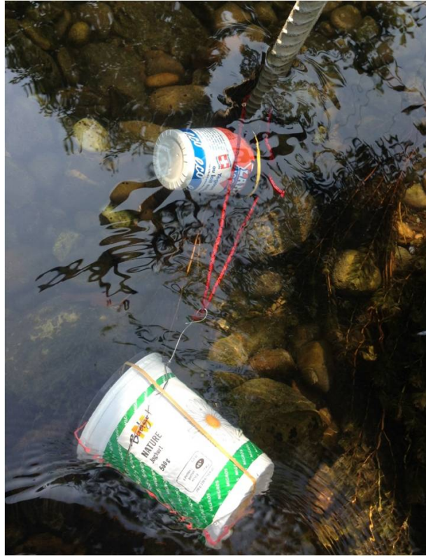
Abbildung 10.7.: Die Becher mit Draht oder Schnur an der Eisenstange befestigen.
