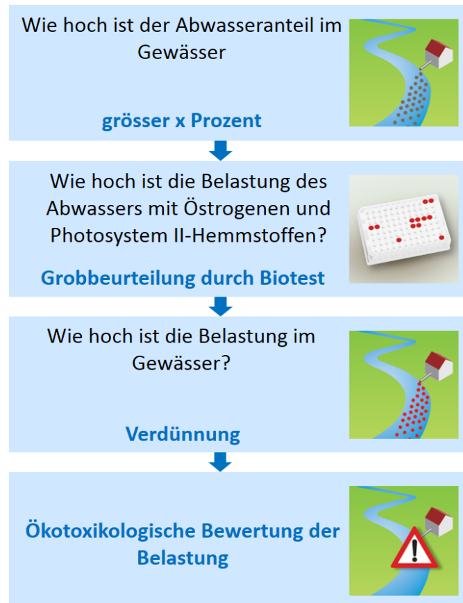
Abb. 2: Elemente des Vorschlags für ein Beurteilungskonzept für die Belastung von abwasserbelasteten Oberflächengewässern mit östrogen-aktiven und Photosystem II-hemmenden Stoffen (Grafik: Eawag).
