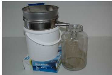
Abbildung 8: Siebsystem zur Isolierung der Fraktion < 63 \mu\text{m} (Foto: Kanton Bern).
