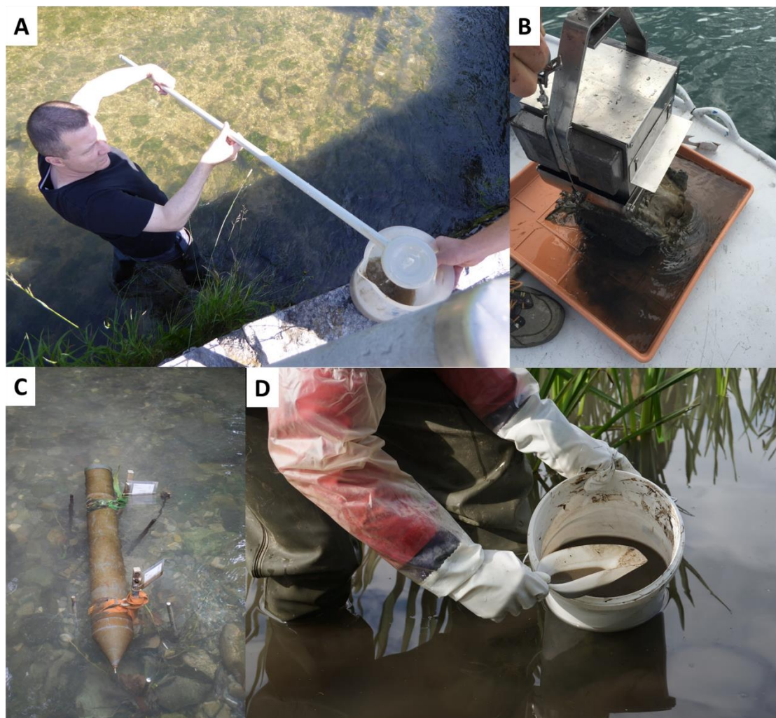
Figure 5 : Différents outils de prélèvement des sédiments utilisables sur le terrain. A) Préleveur télescopique B) Benne type Ekman C) Tube préleveur d'échantillons de sédiments en suspension intégrés en fonction du temps D) Écope.
