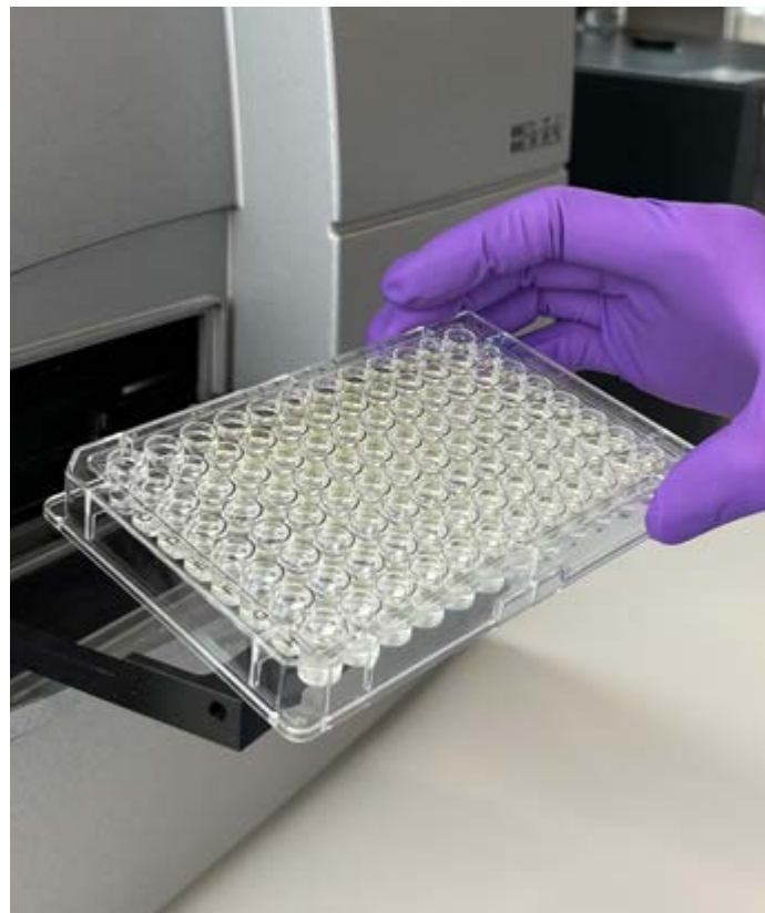
Das Wachstum der Algen auf der Mikrotiterplatte wird im Photometer gemessen.
