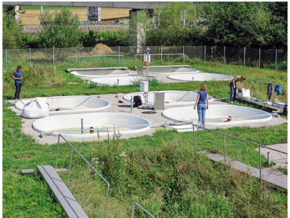
Mithilfe von Experimenten in Versuchsteichen kann erforscht werden, wie sich UV-Filter aus Sonnenschutzmitteln in der Umwelt verhalten.
