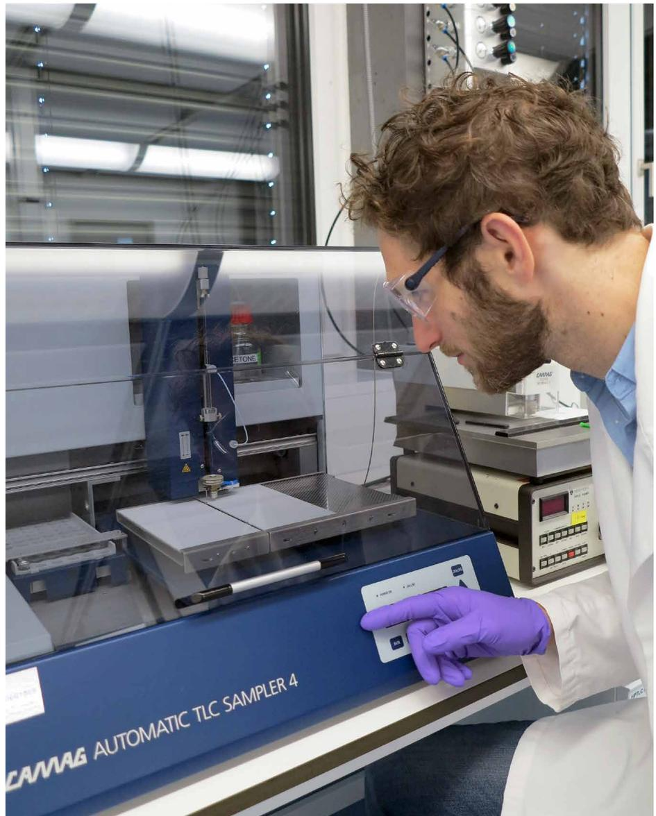
Die Proben werden auf die Dünnschichtplatte gegeben und dort in kleinere Fraktionen aufgetrennt.
